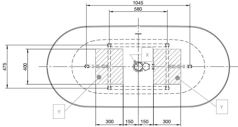
1. toleranties / tolerances  $\pm 10$  mm    2. X = centrum badafvoer / X = centre de l'évacuation du bain    3. Y = suggestie afvoerzone / Y = suggestion pour la zone de l'évacuation
