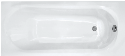
Newform ■ verstevigingslaag met hars en gehakte glasvezel langs buitenzijde, verstevigingspunten en bodemplaat ■ acryl 4 mm excl. versteviging ■ afvoergat diameter 52 mm
