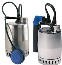
Unilift KP est une pompe submersible compacte en acier inoxydable conçue pour le pompage des eaux non agressives et des eaux grises. Cette pompe peut être utilisée comme unité portable ou une installation fixe à l'intérieur et à l'extérieur des bâtiments.
