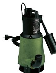
Adaptée au pompage des eaux usées des fosses toutes aisances, la pompe submersible Feka peut traiter des solides en suspension d'une taille allant jusqu'à 25 mm. Le détecteur de niveau permet une installation fixe et assure un fonctionnement automatique.
