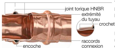
Trois points de pression, un de chaque côté de l'encoche et un point de pression qui comprime le joint torique.
