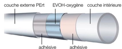
Le tuyau PErt à 5 couches d-floor, étanche à l'oxygène EVOH, selon la norme DIN 4726, est certifié SKZ, ISO et KOMO. Le PErt a le grand avantage d'être remarquablement flexible lors de son utilisation. C'est pourquoi ce type de tuyau est tellement apprécié. Veuillez noter que PErt ne doit pas être utilisé pour les tuyaux de chauffage sanitaire ou chauffage central. Utilisez des coudes guide-tube chauffage sol (179111) !
